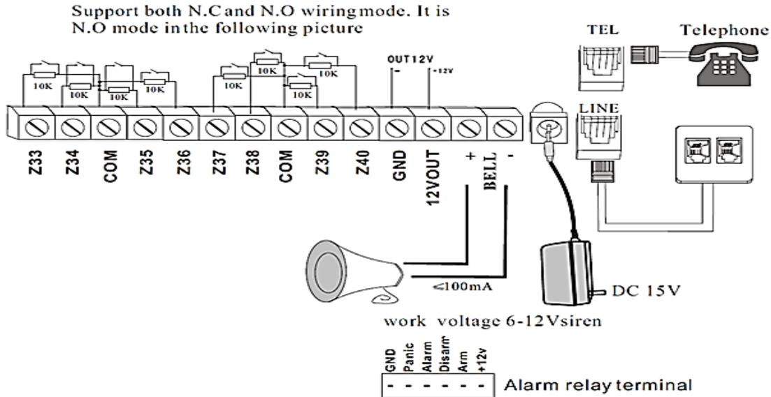
Alarm relay terminal : می تواند ولتاژ ۱۲ ولت را برای LED ویا سوئیچ فراهم نماید.
