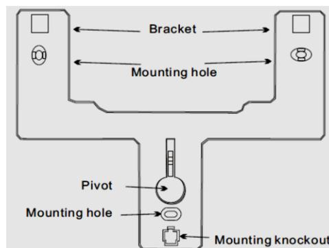
(b) جای سوراخهای پیچ را بر روی دیوار علامت گذاری نموده ، و با استفاده از دریل آن را سوراخ نمایید و براکت را توسط پیچ به دیوار محکم نمایید .
